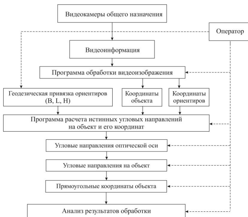
Рис. 2. Этапы обработки информации, зарегистрированной с помощью системы видеорегистрации на базе видеокамер общего назначения
