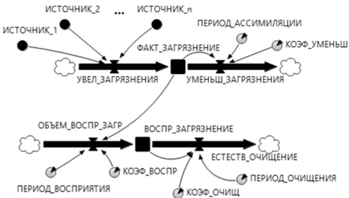
Рис. 4. Шаблон системно-динамической модели загрязнения окружающей среды Fig. 4. The pattern of system dynamics model of environmental pollution
