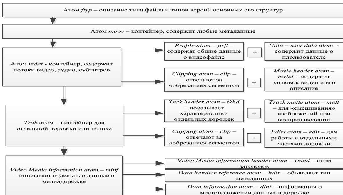
Рис. 5. Типовая структура организации файлового формата MPEG 4
