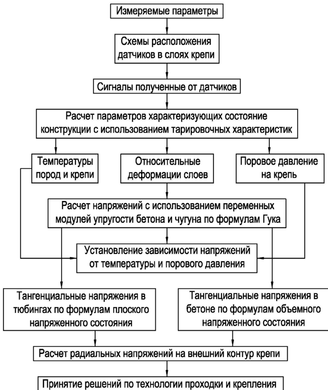
Рис. 2. Блок-схема обработки экспериментальных данных [по: Сергеев и др., 2015; Сергеев, Воробьев, 2015] Fig. 2. Block diagram of experimental data processing [by: Sergeev et al., 2015; Sergeev, Vorobyov, 2015]
